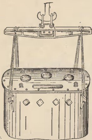
Рис. 1. Подъем трансформатора с помощью траверсы.
